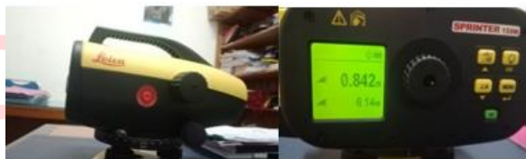
Gambar 28. Tombol measure dan hasil pengukuran
