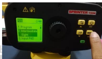
Gambar 34. Menghidupkan/mematikan fitur intermediate sight
