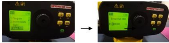
Gambar 35. Pengisian data awal sebelum pengukuran
