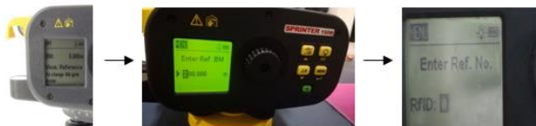
Gambar 39. Pengisian data awal sebelum pengukuran
