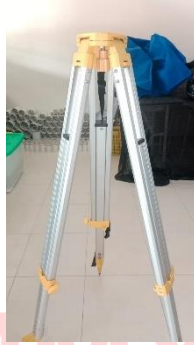
Gambar 26. Statif dalam keadaan stabil
