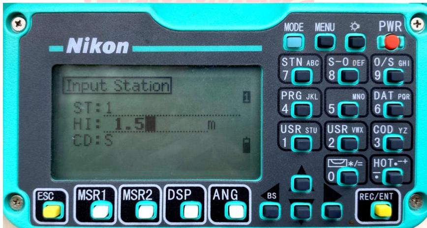
Gambar 66. Input Tinggi Alat
