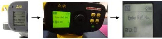
Gambar 32. Pengisian data awal sebelum pengukuran
