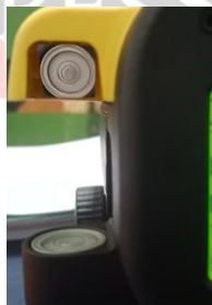
Gambar 27. Nivo kotak berada ditengah (seimbang)
