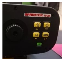
Gambar 29. Tombol kontrol pada Leica Sprinter 150M
